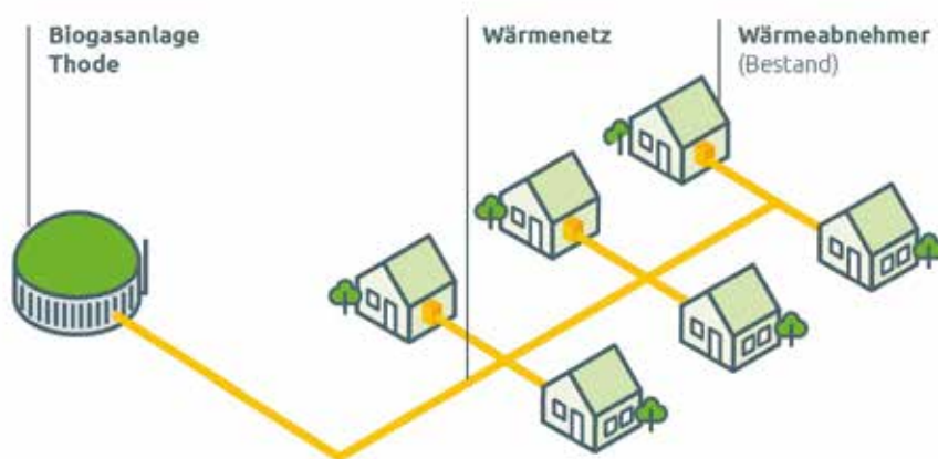
Der Bau der Wärmetrasse beginnt an der Biogasanlage Thode und verläuft im ersten Bauabschnitt entlang der Hauptstraße bis zum REHA-HAUS am östlichen Ortsrand sowie südlich der Hauptstraße.
